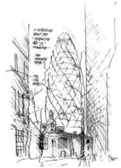
La estructura de 180 metros, se compone de un núcleo central que absorbe principalmente cargas gravitatorias, y una malla perimetral que es la encargada de resistir las cargas horizontales. Permitiendo así una planta libre, y una fachada totalmente transparente
