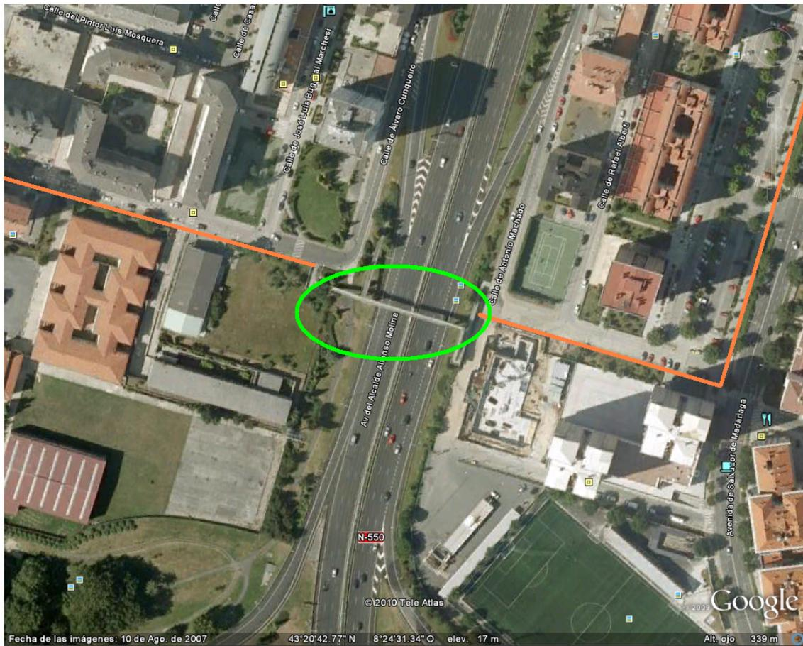
Pasarela actual existente de 80 metros de largo por 2 metros de ancho. Luz máxima de 45-50 metros. Atraviesa 6 carriles de circulación dirección entrada y salida además de dos carriles de acceso a la Avenida
