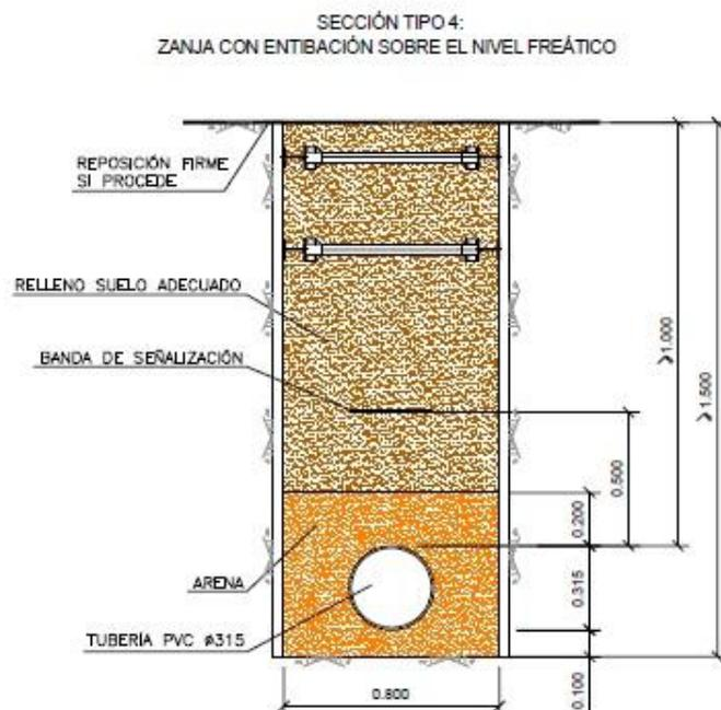
Figura 4: Sección tipo zanja con entibación
