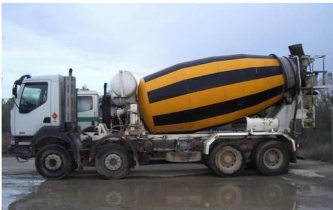
Figura 26: Camión hormigonera
