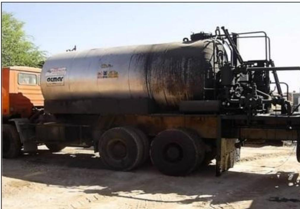
Figura 27: Camión de riego asfáltico
