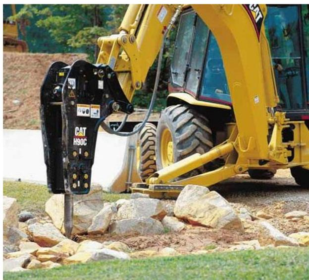
Figura 21: Retro excavadora con martillo rompedor
