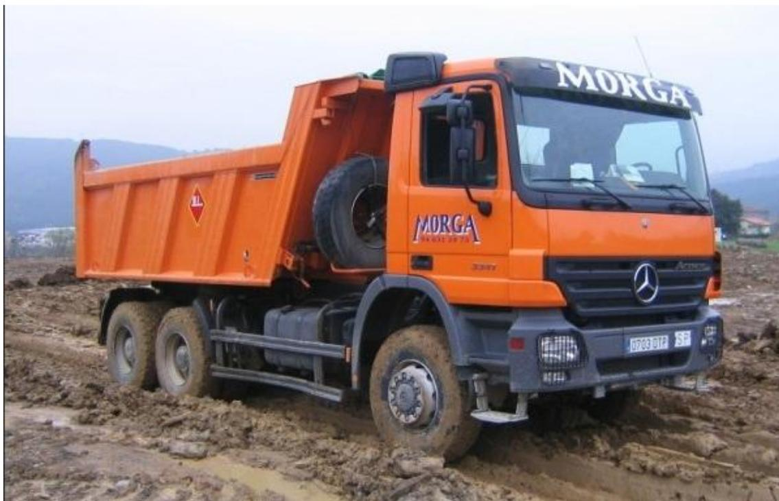
Figura 24: Camión dumper
