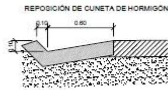
Figura 9: Sección tipo de reposición de cuneta
