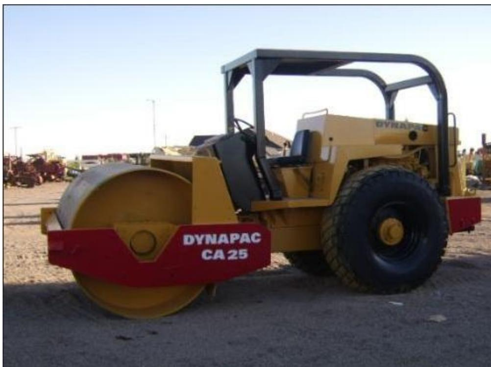
Figura 28: Compactador vibrante
